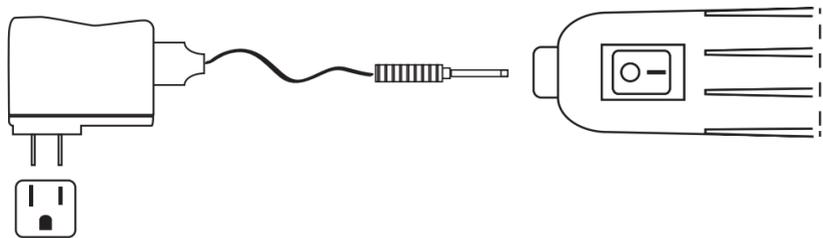
2. Pour recharger la lampe de travail avec l'adaptateur c.c., insérer une extrémité du cordon d'alimentation du chargeur de piles dans le port d'entrée de la lampe, et brancher l'autre extrémité dans une prise c.c. de 12 V standard.
